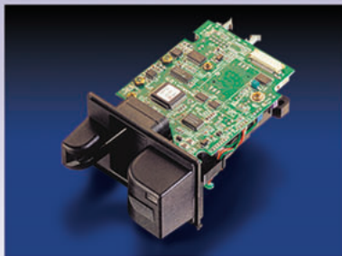
Hibridni čitač kartica ICM 330. Čitač smart, memorijskih i magnetnih kartica. Ručni unos, zaštitni poklopac EMV. RS232 ili USB interfejs.
