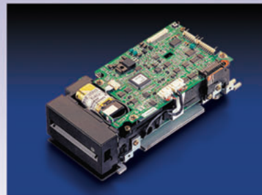
Motorizovani hibridni čitač kartica ICM 330. Čitač smart i magnetnih kartica. 1 SAM socket na ploči. Zaštitni poklopac EMV. RS232 ili USB interfejs.
